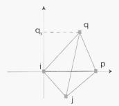
Fig. 4: Positionnement géographique en l'absence de récepteur GPS: chaque terminode s'efforce d'établir une estimation de la distance qui le sépare de chacun de ses voisins. Selon un algorithme réparti, ces données sont ensuite combinées pour construire un repère orthonormé de l'ensemble du réseau, dans lequel les coordonnées de chaque terminode sont alors exprimées.
