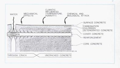
Fig. 3: Fissure à travers laquelle de l'eau ne peut pas s'écouler: apport d'oxygène à la cathode pendant l'amorçage de la corrosion (voir également fig. 4b), puis phase dormante suite à l'auto-colmatage de la zone endommagée et du fond de fissure par le produit de corrosion
