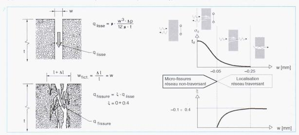
Fig. 6: Auto-colmatage des fissures traversantes possible en cas de faibles variations d'ouverture de fissure et de pression
