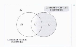
tité supérieure sera disposée dans l'élément. Les codes permettent de nuancer cette quantité d'armature en fonction d'une ouverture de fissure maximale souhaitée. Lorsque le milieu ambiant fait craindre des problèmes de corrosion, il faudra impérativement choisir des diamètres de barres pas trop faibles, c'est-à-dire ne pas chercher à répartir trop finement l'armature minimale.
