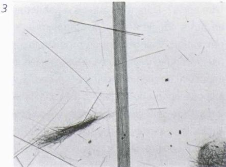
Fig. 1: Roche contenant de l'amiante
