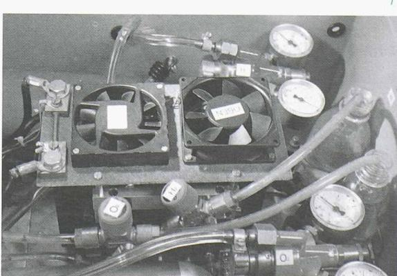
Fig. 1: La première installation de laboratoire développée à l'Institut d'énergie et systèmes électriques de l'EIVD, pour la gestion d'une pile à combustible polymère de 100 W (Photo IAS)
