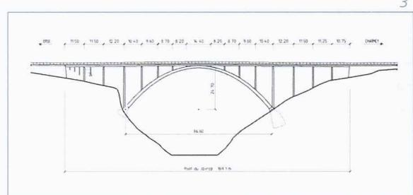
Du point de vue statique, l'arc double est encastré dans le rocher sur la rive droite et dans un massif de béton sur la rive gauche. Le tablier au-dessus de l'arc est continu et lié à ce dernier à la clé. Vers chacune des rives, le tablier était muni, au-delà des piles sur les naissances de l'arc, d'une dalle cantilever, qui permettait d'absorber les dilatations thermiques. Les appuis sur culées étaient conçus comme appuis fixes.
