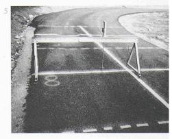
Les résultats ont montré que chacun des produits entraîne une réduction des tassements, qui a été exprimée par un taux d'efficacité (tableau 7). Les meilleurs résultats ont été obtenus avec des géogrilles multicouches, à nœuds rigides en polypropylène, d'une résistance à la traction de 30 kN/m ou plus (fig. 8 et 9).
