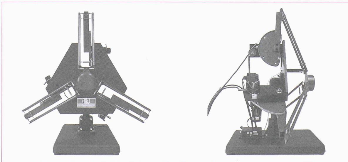
Fig. 2 : Les systèmes à retour de forces permettent une compréhension instinctive des lois agissant au niveau atomique (Photo IRS, EPFL)
