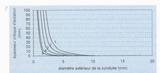
Epaisseur critique de l'isolation en fonction du diamètre extérieur d'une conduite, avec  $h_e = 12 \text{ W/m}^2\text{K}$
