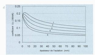
Coefficient de déperdition thermique linéique en fonction de l'épaisseur d'isolation pour conduite en PVC de diamètre  $d_i$  = 5 et  $d_e$  = 8 mm,  $h_e$  = 8 W/m²K 1:  $\lambda$  = 0,06 W/mK,  $e_c$  = 12,5 mm 2:  $\lambda$  = 0,05 W/mK,  $e_c$  = 6,5 mm
