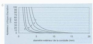
Epaisseur critique de l'isolation en fonction du diamètre extérieur d'une conduite, avec  $h_e = 8 \text{ W/m}^2\text{K}$
