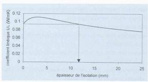
Coefficient de déperdition linéique en fonction de l'épaisseur de l'isolation  $(\lambda=0.03~\text{W/mK})$ , conduite de cuivre  $d_i=4.4~\text{mm}$ ,  $d_e=6~\text{mm}$ ,  $h_e=5~\text{W/m}^2\text{K}$ . Epaisseur critique d'isolation: 12 mm.
