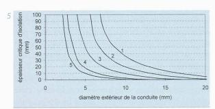
Epaisseur critique de l'isolation en fonction du diamètre extérieur d'une conduite, avec  $h_e = 5 \text{ W/m}^2\text{K}$
