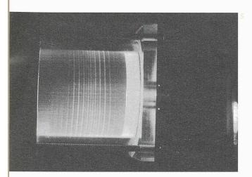
Fig. 3 : Visualisation par nappe oscillante, avec ensemencement en ligne, d'un écoulement en soufflerie sur une aile delta
