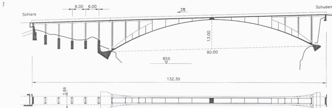
Fig. 1 : Elévation et vue en plan du pont
