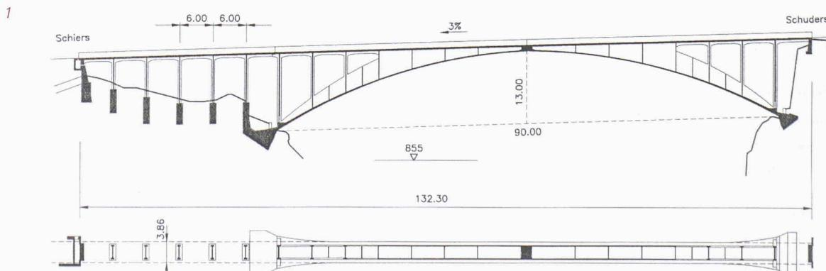
finalement dû être adaptée aux besoins de l'exécution. De l'eau a donc été ajoutée dans les sections minces ou dans les zones à armature dense. D'autre part, le vibrateur n'existant pas encore à l'époque, on a simplement comprimé le béton dans le coffrage et, bien qu'un rapport de l'EMPA l'ait qualifié de béton de haute qualité, il ne répond pas aux normes actuelles, notamment sur le plan de la durabilité.
