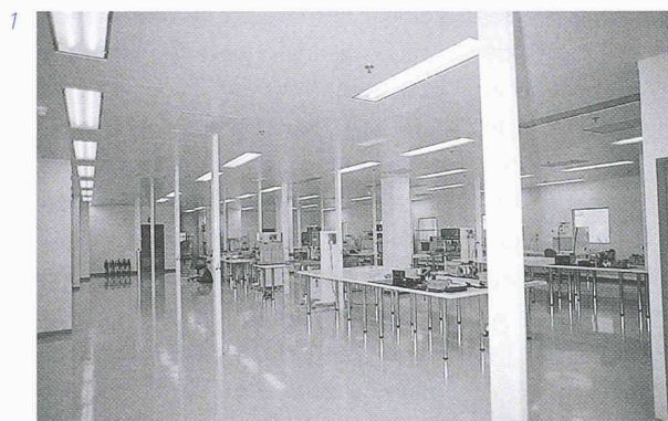
Fig. 2: Vue d'un banc de montage. A noter la présence d'aspirateurs orientables qui permettent d'éliminer une partie de la contamination à la source. Bien que coûteuses, les surfaces vitrées améliorent sensiblement les conditions de travail et permettent de montrer les installations aux visiteurs.
