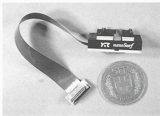
Fig. 1 : Le scanner développé par Nanosurf SA, avec une des puces de l'Institut de microtechnique de l'Université de Neuchâtel (photo FAMARS)
