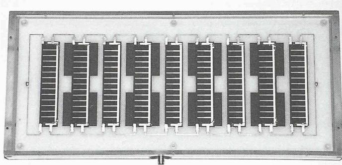
*Fig.6 : Réseau d'antennes à 4 GHz combinées avec des cellules photovoltaïques: l'antenne comprend un préamplificateur alimenté par les cellules, d'où un gain d'environ 30 dB (photo LEMA)*
