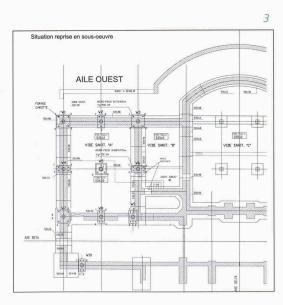
Fig. 1: Plan de situation des travaux spéciaux Fig. 2: Reprise en sous-œuvre d'un pilier
