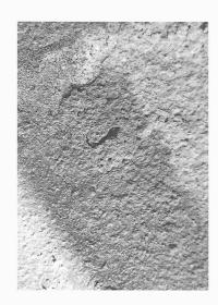
permanente demeure relative: le rapport entre l'épaisseur de la pellicule et la perte d'épaisseur du matériau étant de l'ordre de dix à un, une plaque de rouille de 5 mm d'épaisseur correspond à une perte d'environ 0,5 mm sur la tôle.
