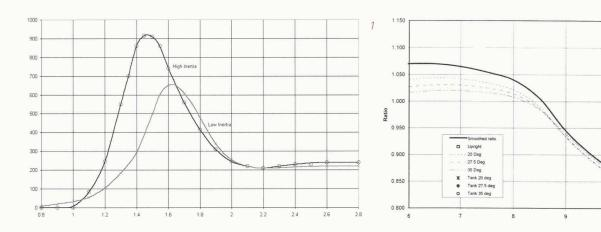
la résistance totale fut observée avec la configuration à double quille: 8% ou plus, pour des vitesses modérées à élevées (supérieures à 8 nœuds), à la fois en position droite ou avec de la gîte.
