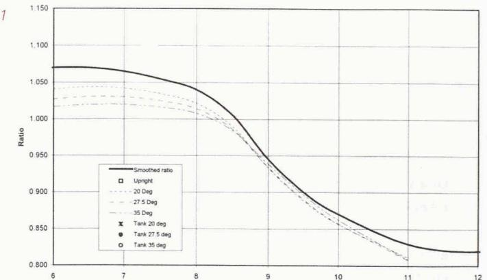
la résistance totale fut observée avec la configuration à double quille: 8% ou plus, pour des vitesses modérées à élevées (supérieures à 8 nœuds), à la fois en position droite ou avec de la gîte.
