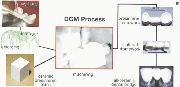
Le procédé de fabrication de la prothèse céramique : les opérations de prise de données et d'usinage dans un bloc d'oxyde de zirconium pré-fritté sont automatisées (Direct Ceramic Machining) - (photo ETH-Ceramics)
