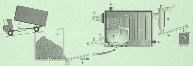
La chaufferie de Courtelary: 1. silo d'alimentation; 2. extracteurs à échelles; 3. vérin hydraulique; 4. vis de dosage; 5. foyer à vis de poussée; 6. ventilateur de combustion; 7. brûleur à mazout de secours; 8. échangeur de chaleur en plaques; 9. retour d'eau; 10. départ eau chaude; 11. filtre cyclonique; 12. raccordement cheminée; 13. vis de décendrage du foyer; 14. vis de transport des poussières; 15. conteneur à cendres.
