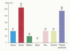
Fig. 1. - Elasticité comparée de divers matériaux
