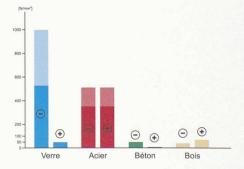
Fig. 2. - Résistances comparées de divers matériaux
