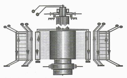
Fig. 6 – Schéma du système de refroidissement à eau
