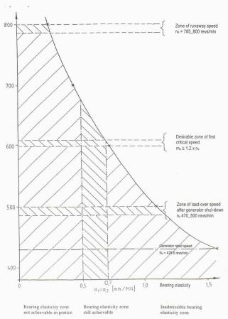
Fig. 4 – Première vitesse de rotation critique de l'arbre en fonction de l'élasticité des paliers
