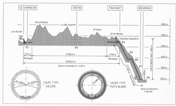
Fig. 1 – Galerie d'amenée et puits blindé de l'usine de Bieudron: profil en long et coupes types
