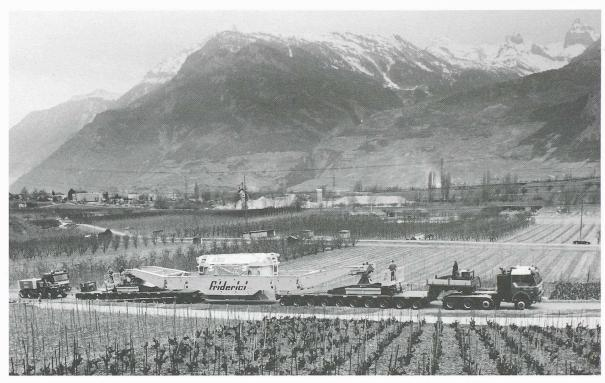
Fig. 11 – Transport d'un transformateur sur remorque construite ad hoc (photo H. Preisig, Sion)
