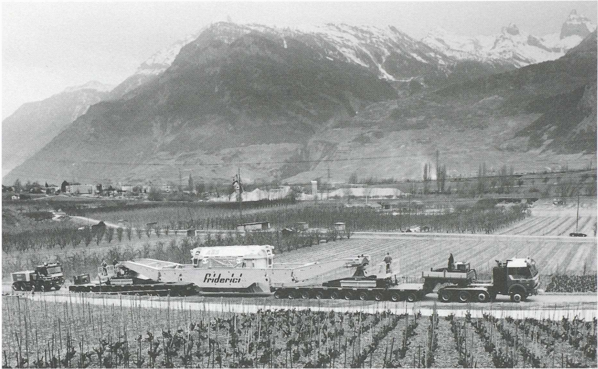
Fig. 11 – Transport d'un transformateur sur remorque construite ad hoc (photo H. Preisig, Sion)
