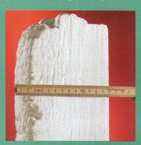
Le comportement des éléments de construction en plâtre sous l'effet des hautes températures est universellement reconnu. Les cloisons en carreaux de plâtre Alba de 6, 8, 10 cm sont classées comme parties de construction résistantes au feu; celles en Alba de 14 cm comme hautement résistantes au feu.
