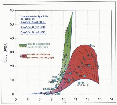
Fig. 5. - Diagramme pH-CO<sub>3</sub><sup>--</sup> avec les domaines de dissolution de portlandite (en rouge) et de calcite (en vert) par rapport au chimisme de l'eau du lac, avec pH et concentration en  $CO_3$ <sup>--</sup> des eaux sortant des drains. Les drains dans le domaine de la portlandite témoignent d'une dissolution de l'écran d'étanchéité
