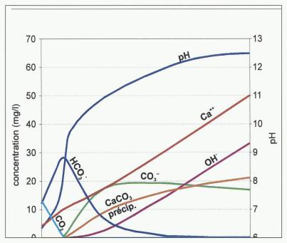
Fig. 3: Modèle de dissolution de la portlandite dans une solution aqueuse au chimisme du lac du Naret (pH = 6,4;  $Ca^{++} = 4 \text{ mg/l}$ ;  $HCO_3^- = 12 \text{ mg/l}$ )
