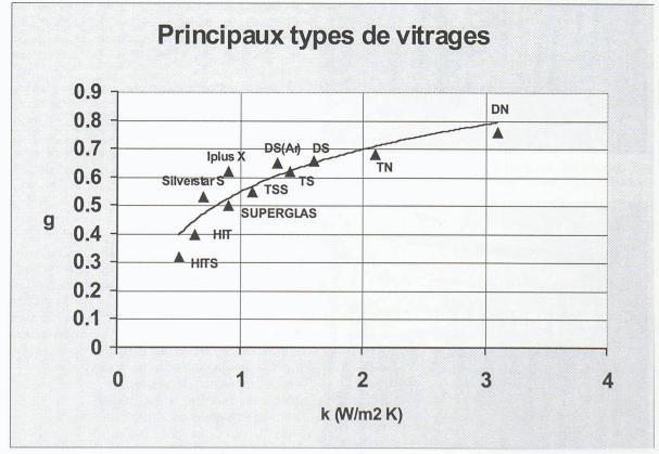
Figure 1.- Transmission énergétique totale (g), en fonction du coefficient de transmission thermique (k)
