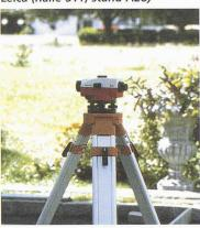
Leica Geosystems SA complète sa gamme de niveaux automatiques par le BasicLevel, un nouveau modèle, solide et fiable, qui est l'outil idéal pour les petits comme les gros chantiers et qui s'adaptera à coup sûr au budget de chacun. Grâce à un ajustage aisé de la ligne de visée et un compensateur hautement résistant, la précision
