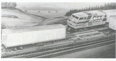
Fig.2.- «L'iron Highway» pourra emporter jusqu'à 120 véhicules à une vitesse supérieure à 100 km/h (Source La Vie du Rail)
