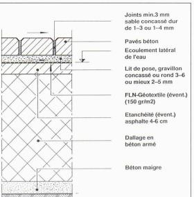
Pavage sur dallage avec drainage du lit de pose
