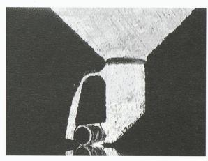
Fig. 4 – Micro-préhenseur développé par l'Institut de systèmes robotiques de l'EPFL. Cette pince, de 1 mm sur 1 mm, saisit une lentille de 250 microns. Le mouvement de préhension est assuré par l'effet mémoire de forme (photo EPFL)
