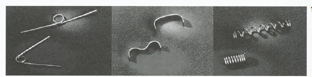
Fig. 2 – Une caractéristique des alliages à mémoire de forme: leur capacité à changer de forme avec la température. En dessous, la forme basse température; en dessus, la forme haute température. Le passage d'une forme à l'autre est réversible. (photo Memry)
