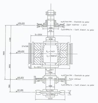
Fig. 8 - Calcul de la ligne d'arbre d'un groupe
