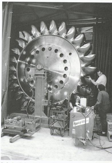
Fig. 7 - Contrôle de qualité d'une roue Pelton
