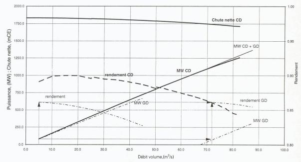
Fig. 5 – Caractéristiques de fonctionnement des turbines sous Hbrute = 1883 mCE (mCE: mètre de colonne d'eau; CD: Cleuson-Dixence avec l'usine de Bieudron; GD: Grande-Dixence avec les usines de Fionnay et de Nendaz)
