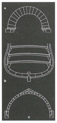
Fig. 6.- Les sources techniques du principe de la charpente de Philibert de l'Orme (reproduites avec l'aimable autorisation des Compagnons du Devoir) a) arc de pierre
