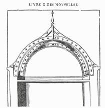
Fig. 1.- Ferme proposée par Philibert de l'Orme dans son ouvrage paru en 1567
