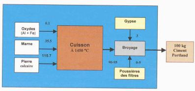
Fig. 1. – Processus de fabrication du ciment Portland [ESU 95]
