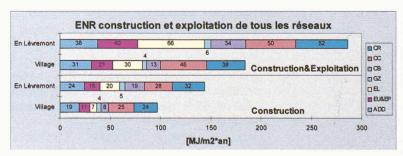
Fig. 4. – Contribution en énergie primaire non renouvelable des réseaux en phase de construction (bas) et avec ajout de l'exploitation (haut). ADDuction, Eaux Usées & Pluviales, ELectricité, GaZ, Circulation dans le Bâti (zones habitées), Circulation dans la Commune (territoire communal), Circulation dans la Région (voies utilisées pour se rendre au travail)
