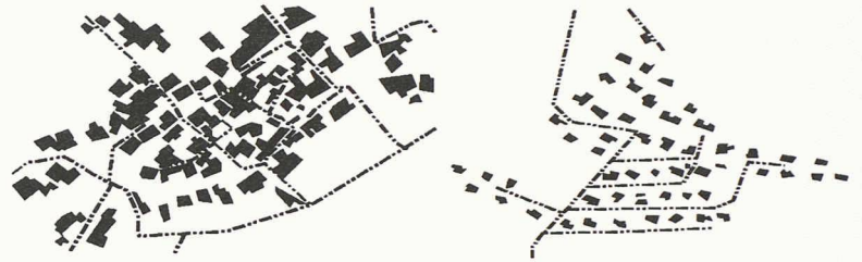
Fig. 2. - Vision schématique du centre historique d'Apples (gauche) et du quartier périphérique d'En Lèvremont (droite). Les pointillés correspondent aux principaux collecteurs du réseau des égouts.
