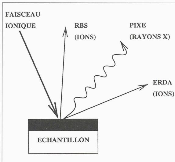
Le schéma ci-contre illustre le principe d'analyse par faisceau ionique. Un accélérateur Van de Graaff produit le faisceau primaire d'ions légers ( $H^+$ ,  $He^+$ ) mononcinétiques, accéléré sous une tension de 0,5 à 3,5 MeV. Une faible fraction de ces ions est rétrodiffusée
