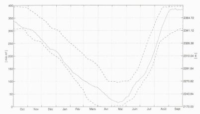
Fig. 1 – Lac des Dix: variation du niveau du lac et du volume d'accumulation le long de l'année (évolution 1996-1997, minimum et maximum entre 1966 et 1996)
