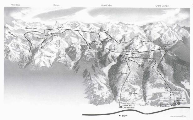
Fig. 2 – Le barrage de la Grande-Dixence, alimenté par des galeries d'adduction et des stations de pompage, permet d'accumuler les eaux de plusieurs hautes vallées des Alpes valaisannes, dont l'énergie est mise en valeur par des centrales hydroélectriques.
