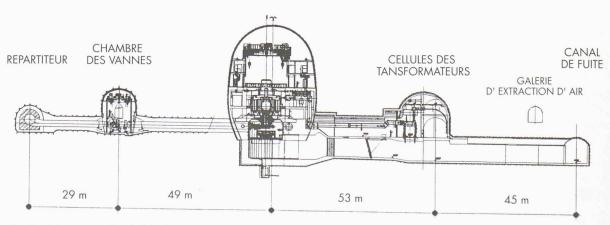
Fig. 8 – Usine souterraine de Bieudron: coupe transversale
