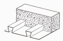
Fig. 4.- Dalle avec tôle Holorib
