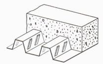
Fig. 5.- Dalle avec tôle embossée
