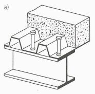
Fig. 7.- Ancrages d'extrémité a) par goujons soudés b) par écrasement des nervures
