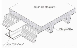
Fig. 6.- Tôle profilée pour «slim-floor»
