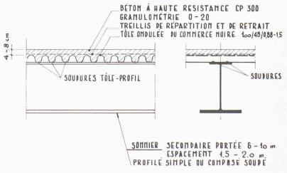
Fig. 3.- Plancher mixte avec tôle ondulée (figure tirée de [2])
