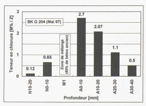
Fig. 3.- Profil de répartition des teneurs en chlorures dans le béton neuf, originellement dépourvu de chlorures (N), et dans le béton ancien (A) pour la surface de test n'ayant pas subi d'enlèvement de béton sur la paroi amont de la galerie de Güetli
