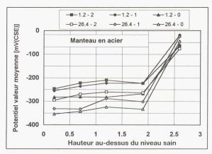
Fig. 2.- Valeurs moyennes de la mesure de potentiel initiale (21.6.1996) ainsi que des première et deuxième mesures ultérieures (30.10.96 et 26.6.97) effectuées sur la hauteur des piles remises en état (piles Nº 1.2 et 26.4) dans la galerie de Güetli en 1996
