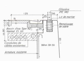
Fig. 14.- Bande d'arrêt avec couronnement existant
