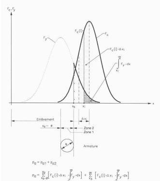
Fig. 4.- Probabilité de dépassivation suite à l'enlèvement d'un béton carbonaté
