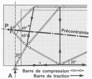
Fig 5. - Modélisation en treillis
