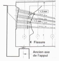
Fig. 4. - Fissures dans les poutres longitudinales
