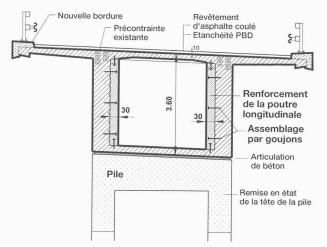
Fig. 10. – Renforcement au voisinage d'une poutre longitudinale
