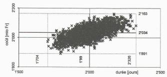
Fig. 1.— Diagramme temps-coûts du génie civil pour le tunnel de base du Lötschberg (1 an correspond à 320 jours de travail).
