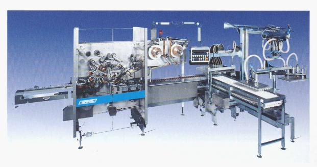
Fig. 4. – La MULTISTYLE avec un poste d'alimentation automatisé. Le passage des chocolats dans le revolver de pliage est bien visible sur la partie gauche de la photo (photo SAPAL)
