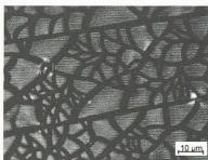
Fig. 3 – Réseaux de fissures dans la couche  $SiO_x$  observée en microscopie optique sous contrainte uniaxiale (gauche) et équibiaxiale (droite)
