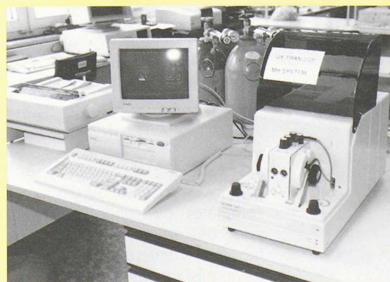
Dispositif Oxtran pour la mesure de la perméabilité à l'oxygène de films d'emballage et d'emballages complets
