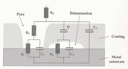
Modèle d'un substrat métallique recouvert d'une couche polymère et présentant certains défauts, ainsi que le circuit électrique équivalent
