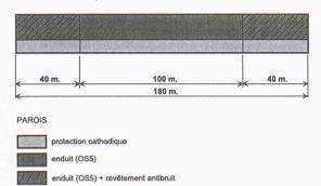
Fig. 2.- Schéma du principe d'assainissement
