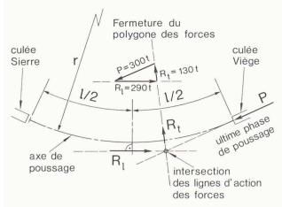
Fig. 5.- Application au cas des viaducs lle Falcon: Ultime phase du poussage, avec un effort de poussage admis pour l'exemple à 3000 kN = 300 t
