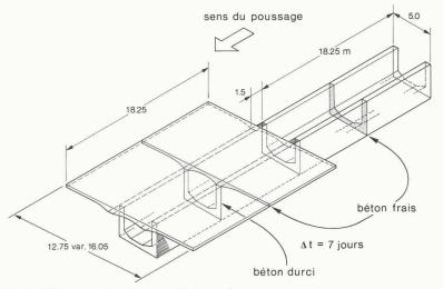
Fig. 6.- Bétonnage du caisson en plusieurs phases
