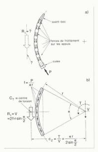
Fig. 4.- Résultante des forces de frottement
