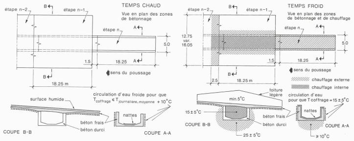
Fig. 7.- Bétonnage de la section en été
