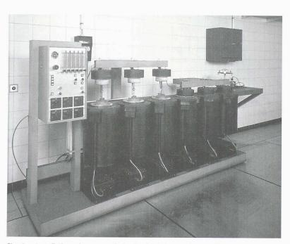
Fig. 1. – Installations de mesure de la réactivité des anodes au  $CO_2$ . Les carottes sont chauffées puis refroidies et leur perte de poids est précisément enregistrée.
