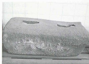
Fig. 2. – Anode endommagée par une combustion au \text{CO}_2
