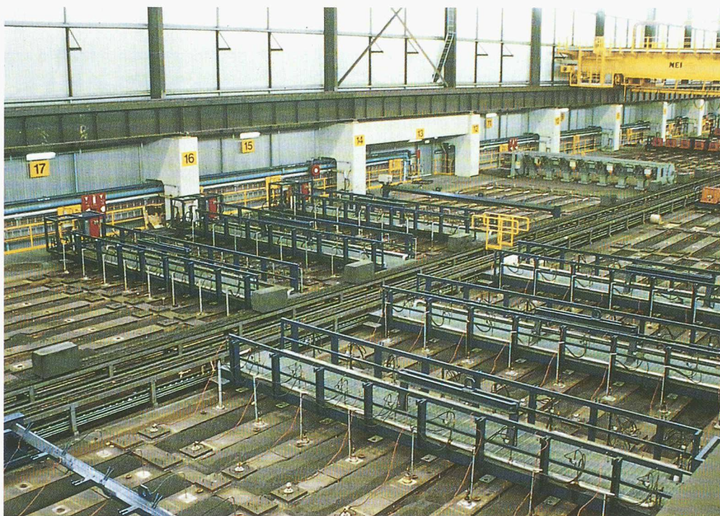
Fig. 5. – Four de calcination d'anodes: les systèmes de combustion (au premier plan) et de refroidissement se déplacent le long des traverses. Un cycle complet de cuisson et refroidissement dure deux semaines.
