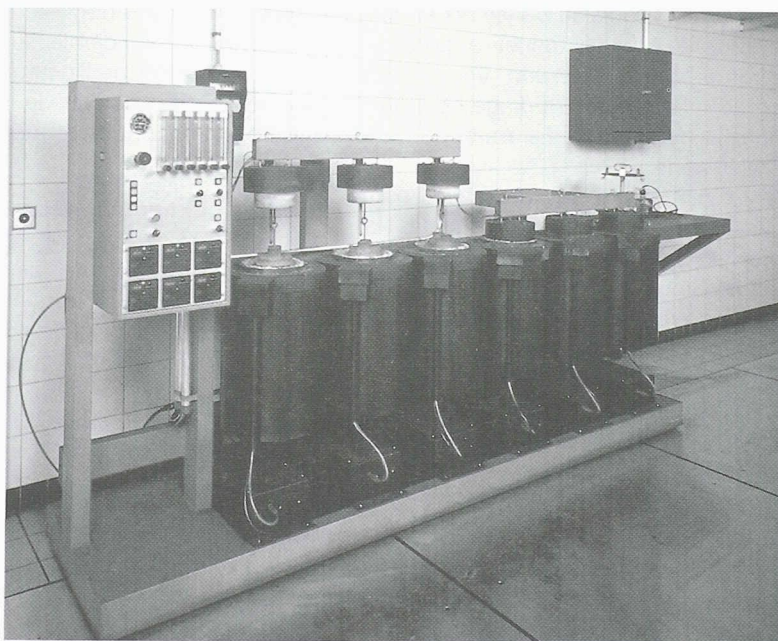
Fig. 1. – Installations de mesure de la réactivité des anodes au \text{CO}_2 . Les carottes sont chauffées puis refroidies et leur perte de poids est précisément enregistrée.
