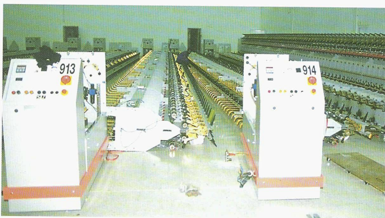
Fig. 8.- Machines de tissage qui ont été renversées au sol du fait de la sollicitation sismique qu'elles ont subie
