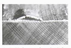
Fig. 3.- Décollement en forme de toit d'une couche de peinture sur bois provoqué par le retrait du bois sous l'action de l'air sec (largeur de l'image 18 mm, photo: K. Zehnder)
