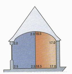
Fig. 9.— Eglise réformée d'Ebnat avec chauffage sous les bancs et ancien système de commande (mode de chauffage intermittent). Températures mesurées à une température extérieure de – 3°C; à gauche sans chauffage; à droite avec chauffage. Conditions relevées six heures après l'enclenchement du chauffage: augmentation rapide de la température ambiante de 15 K en l'espace de six heures, forts écoulements d'air froid, températures égales à hauteur des bancs et sous le plafond.
