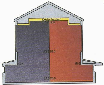
Fig. 10.- Eglise catholique d'Uzwil avec chauffage par le sol (mode de chauffage permanent). Températures mesurées à une température extérieure de –1°C, à gauche à l'état tempéré, à droite dans les conditions relevées trois heures après l'enclenchement du chauffage: augmentation de la température de l'air ambiant de 2 K au niveau des bancs (capteurs de température sous les bancs), écoulements d'air froid lorsque le nombre des occupants est élevé.
