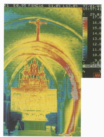
Fig. 7.— Cathédrale de Coire. Thermogramme de la zone de l'autel lors d'un chauffage modéré (température de sortie de l'air chaud: 28°C) le 9.1.97. L'échelle de couleur du bleu au rouge correspond au domaine de température de 10 à 60°C. On distingue clairement le réchauffement plus fort de la partie supérieure du maître-autel (rouge) et les parties des murs et de l'arche du chœur réchauffées par le jet d'air chaud (rouge clair).
