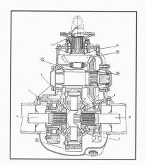
Fig. 8. – Différentiel mécanique de voiture
