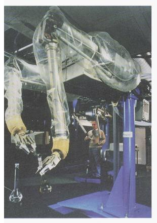
n. 1. – Essai du manipulateur maître-esclave à retour de force ascot4 du JET. Ce manipulateur est capable de saisir aussi bien de tits objets, avec une sensibilité extrême (jusqu'à 70 gr.), que des ids de 20 kg (photo JET).
