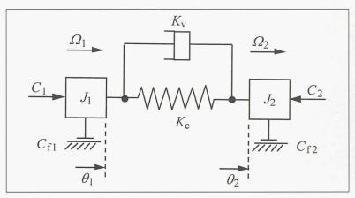
Fig. 2. – Equivalent mécanique d'un servosystème bilatéral
