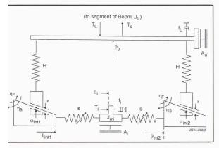
a. 4. – Equivalent mécanique d'un actionneur du Boom
