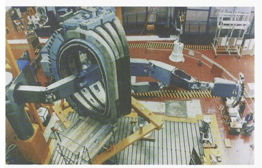
ig. 3. – Transporteur robotique Boom du JET, utilisé pour pénétrer à l'intérieur du tore. Capable de porter à son out le Mascot4 ou d'autres outils, ce bras mince, de douze mètres de long peut recevoir une charge de 350 kg photo JET).
