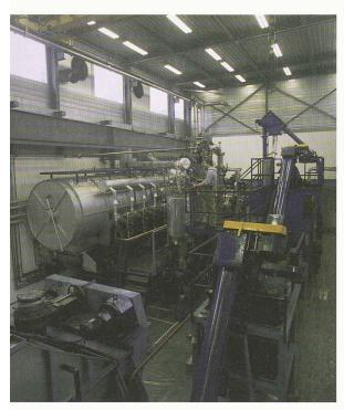
our à pyrolyse pour le traitement des piles usées chez Recymet SA. e procédé à faible température (650°C) est utilisée pour séparer s oxydes métalliques et les métaux des matières non désirées nercure, plastiques, etc.). La pyrolyse à 650°C évite des investisements comparables à ceux des fours de fusion. Le minerai prouit s'intègre ensuite dans la chaîne de revalorisation du zinc des ciéries européennes (photo Poite).
