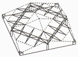
Fig. 1 – Vélodrome de Bordeaux: principe de structure
